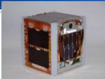
世界初の1kg衛星 新規技術の宇宙 成功 XI-IV(2003) 実証XI-V(2005)
